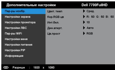
**ЦВЕТ. ТЕМП**—Настройка цветовой температуры. При более высокой цветовой температуре изображение на экране выглядит холоднее, а при более низкой — теплее. При изменении значений параметров в меню **Настройка цвета** активируется режим «Пользов.». Значения параметров сохраняются в режиме «Пользов.».
