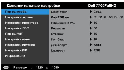
**ЦВЕТ. ТЕМП**—Настройка цветовой температуры. При более высокой цветовой температуре изображение на экране выглядит холоднее, а при более низкой - теплее. При изменении значений параметров в меню **Настройка цвета** активируется режим «Пользов.» Значения параметров сохраняются в режиме «Пользов.».
